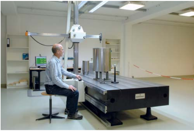
Abbildung 12: 3D-Messtisch zur mechanischen Vermessung
