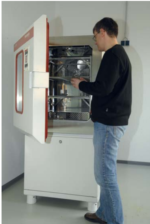
Abbildung 14: Messschrank für Temperaturwechsel- und Feuchteprüfungen.
