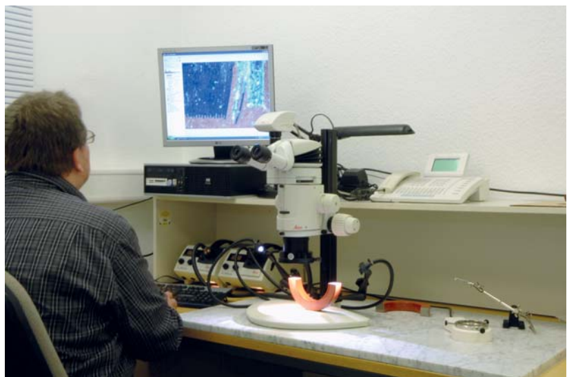
Abbildung 11: Lichtmikroskop für qualitätssichernde Untersuchungen
