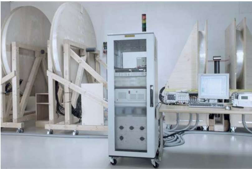
Abbildung 9: Helmholtz-Messplatz für die Messung von Abschirmfaktoren
